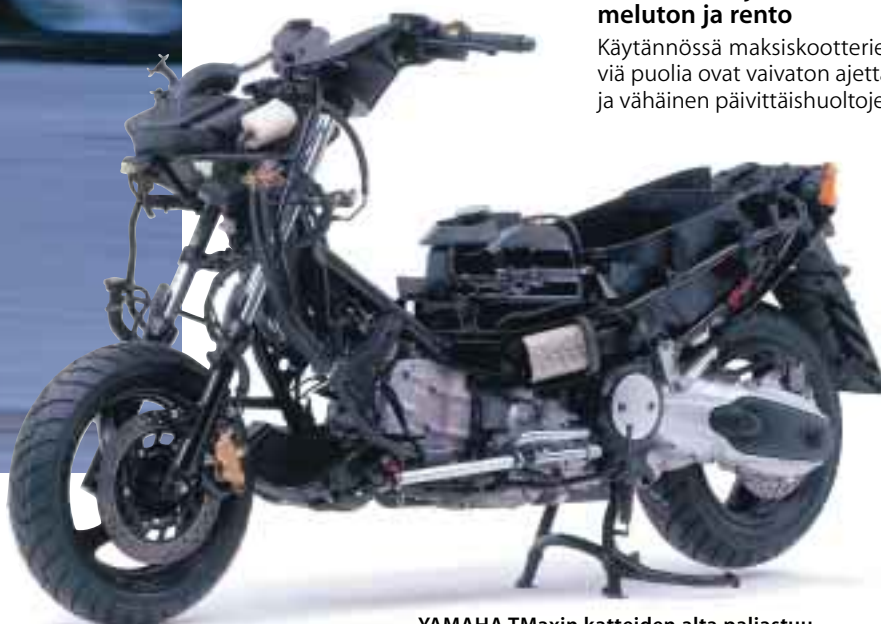
YAMAHA TMaxin katteiden alta paljastuu moottoripyörämäinen kokonaisuus, esimerkiksi kaksisylinterinen moottori on kiinnitetty moottoripyörän tavoin suoraan teräsputkirunkoon ja vaakatasossa oleva takapään iskunvaimennin jää melkein kokonaan moottorin katveeseen.
